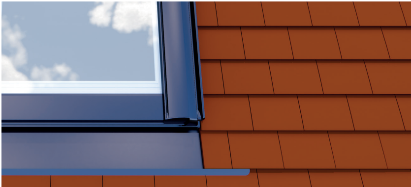
Rame EDP – pentru plăci simple mici (lungime maximă 300 mm, grosime maximă 14 mm) Exemple de acoperiri: + țigle plane din beton Pentru pante de acoperiș de 15° – 90°
