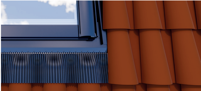
Rame EDU – pentru plăci profilate de până la 120 mm Exemple de acoperiri: + olane + țiglă tip "mediteraneană" Pentru pante de acoperiș de 15° – 90°
