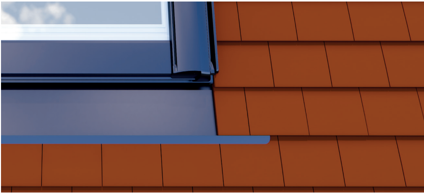
Rame EDS – pentru învelitori plate de până la 3 cm grosime Exemple de acoperiri: + ardezie + țiglă plană tip solzi cu suprapunere dublă + țiglă plană din beton + șindrilă + membrană bituminoasă Pentru pante de acoperiș de 15° – 90°
